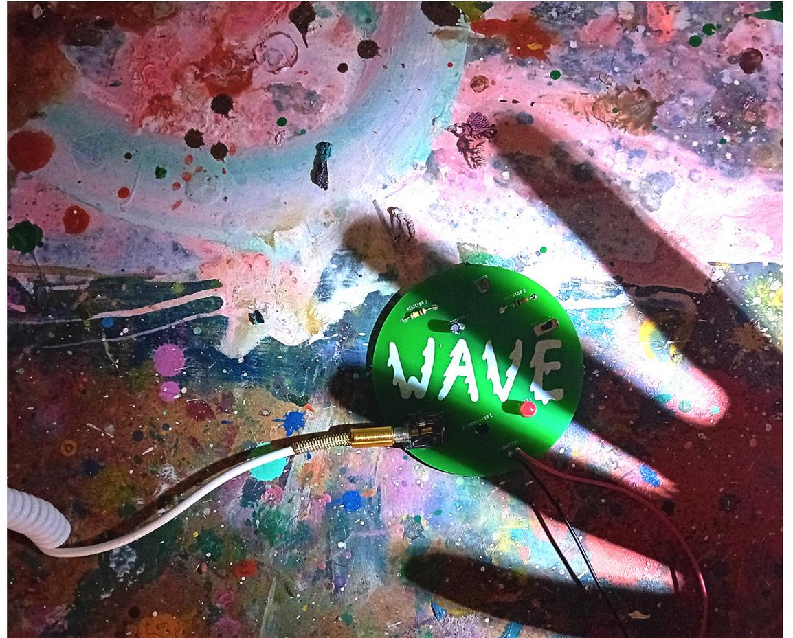
Eine Taschenlampe wird als Lichtquelle verwendet. Im Zusammenspiel mit einer Hand entsteht ein Licht-Schattenspiel. Fällt der Schatten der Hand über den Sensor von «Wave» fällt die Frequenz des Klanges in die Tiefe.
