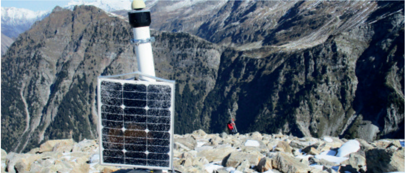
GPS-Antenne zur Überwachung von Bodenbewegungen im Zuge des Rückgangs des Permafrosts in Bergregionen. Foto: C. Scapozza, IST-SUPSI
