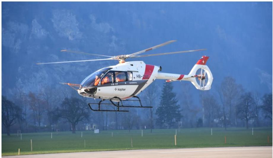
P3 startete heute vom Flugplatz Mollis und absolvierte erfolgreich den ersten Testflug, der insgesamt 40 Minuten dauerte und eine Reihe von Manövern umfasste, mit denen erste Flugdaten gewonnen, bestimmte Konstruktionsdetails validiert und die Flugqualität bewertet wurden.
